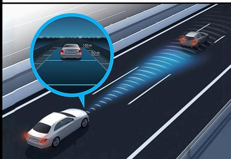
El asistente de distancia DISTRONIC facilita considerablemente la tarea del conductor al volante, ya que regula de forma automática la distancia con respecto al vehículo de en frente. Además, aproximándose a una curva el sistema reduce de forma anticipada la velocidad.
