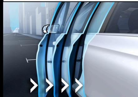
Las puertas delanteras y traseras de su vehículo encajan en la cerradura prácticamente sin hacer ruido. Solo tendrá que cerrar las puertas hasta el primer encaje y del resto se ocupa su vehículo por usted. Es decir, si no se cerró la puerta con suficiente fuerza, el sistema de Servocierre cierra completamente la puerta.
